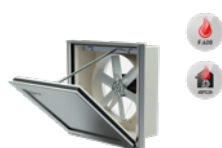
THT/WALL-F Extracteurs dynamiques muraux avec clapet à ouverture motorisée, pour l'évacuation des fumées d'incendie, 400 °C/2h et 300 °C/2h
